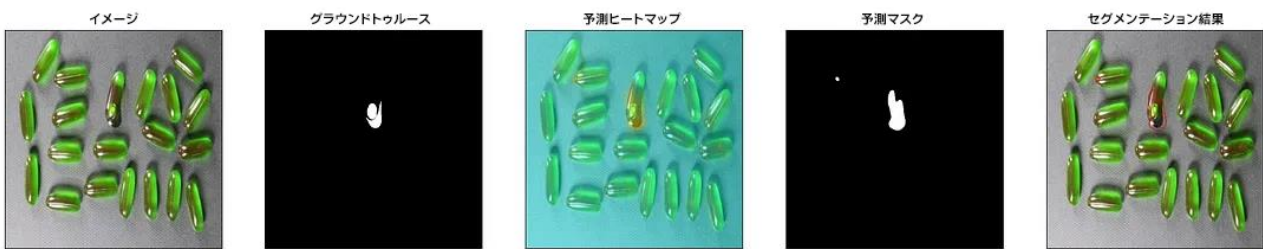
図 1: VisA データセットの異常検出のサンプル。このサンプルでは、カプセルの不具合を見つけます。
