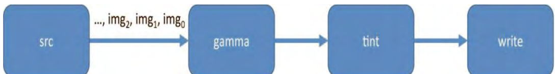
図 1-9. 4 つのノードを持つデータ・フローグラフ: (1) 画像を取得または生成するノード、(2) ガンマ補正を適用するノード、(3) 色合いを適用するノード、および (4) 結果画像を書き出すノード
