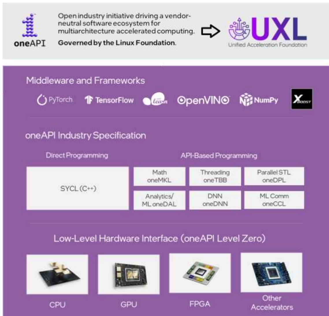
図 2: UXL が推進する SYCL* 上に構築された oneAPI ソフトウェア・スタック
