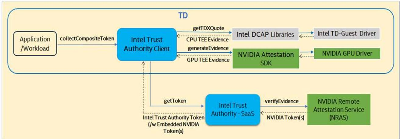
このオプションでは、インテル® Trust Authority クライアントがインテル® TDX および NVIDIA\* H100 GPU から構成証明を収集し、インテル® Trust Authority SaaS を呼び出し、インテル® Trust Authority SaaS が NRAS を呼び出して、検証済みの構成証明と NVIDIA の署名付きトークンを取得します。
