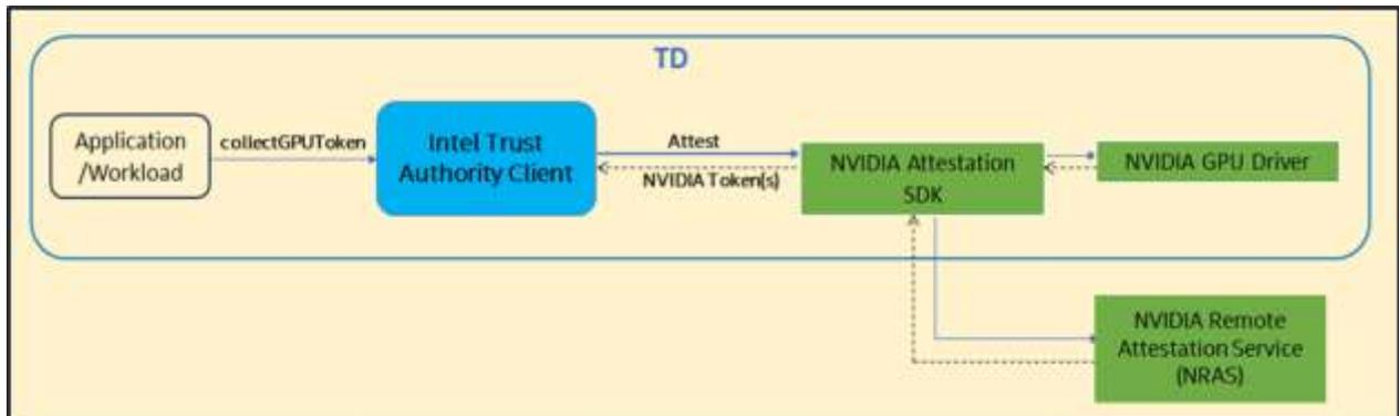
このオプションでは、インテル® Trust Authority クライアントは、インテル® Trust Authority SaaS を呼び出さずに、NRAS を直接呼び出して GPU 認証を行います。NVIDIA\* H100 GPU TEE のリモート認証は、インテル® Trust Authority SaaS を介さずに、NRAS によって直接実行されます。
