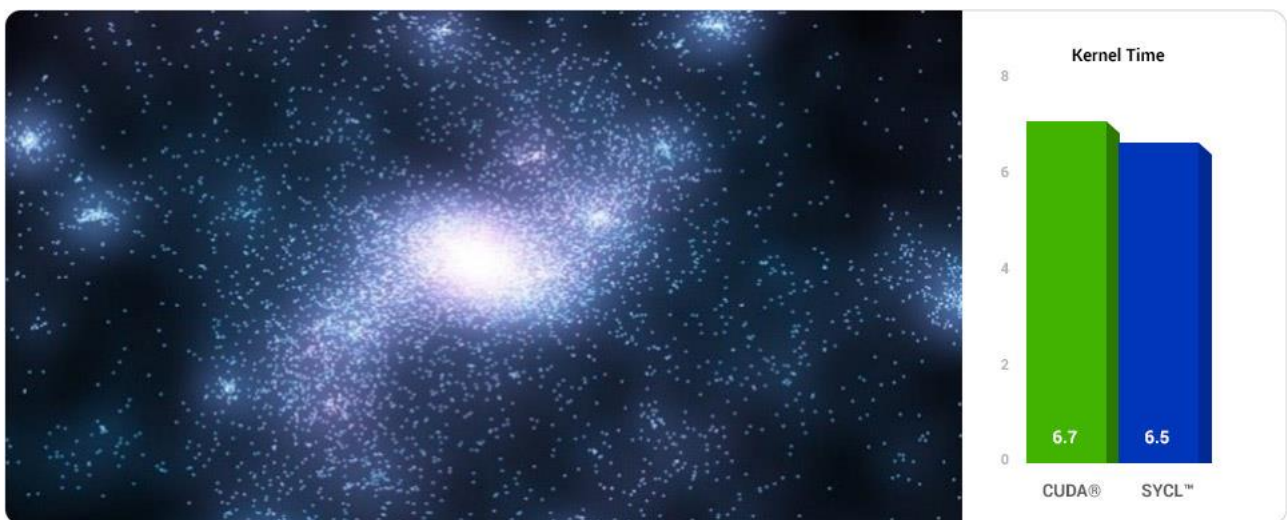
図 1. SYCLomatic を使用して CUDA* から SYCL* に移行した NBODY シミュレーションの出力。CUDA* バージョンはカーネル内で平均 6.7ms を費やしているのに対し、CUDA* バックエンドで動作する SYCL* バージョンは平均 6.5ms を費やしています。†
