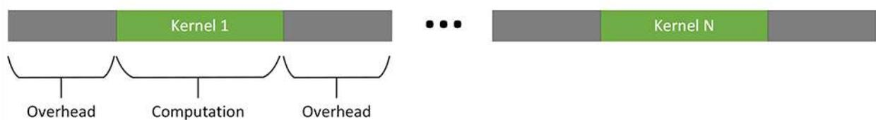
これを解決する 1 つの方法は、複数の小さなカーネルを 1 つの大きなカーネルに融合することです。融合カーネルは、次の図に示すように、計算量 / オーバーヘッドの比率が向上するため、デバイスカーネルの起動オーバーヘッドを相殺しやすくなります。
