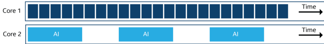
図 2. デュアルコア実行。コア 2 で AI ティックを 1/10 秒ごとに更新し、コア 1 はできるだけ多くのフレームをレンダリングします。
