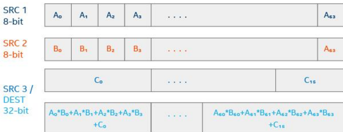
図 1. インテル® AVX-512 VNNI VPDPBUSD 命令は FMA ユニットごとにクロックサイクルあたり 64 の符号付き 8 ビット値と 64 の符号なし 8 ビット値を乗算して 16 の符号付き 32 ビット値に融合 (FMA ユニット数はコアあたり最大 2 つ)。謝辞: Israel Hirsh
