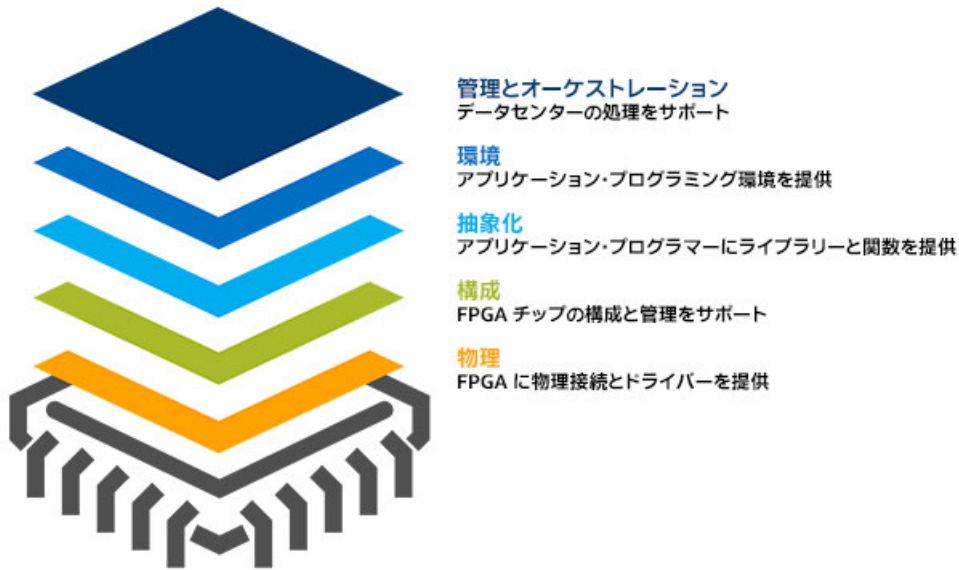
図 2. FPGA アクセラレーションをユーザーが利用できるようにするために必要なタスクとツールを概念的に示した適合スタック
