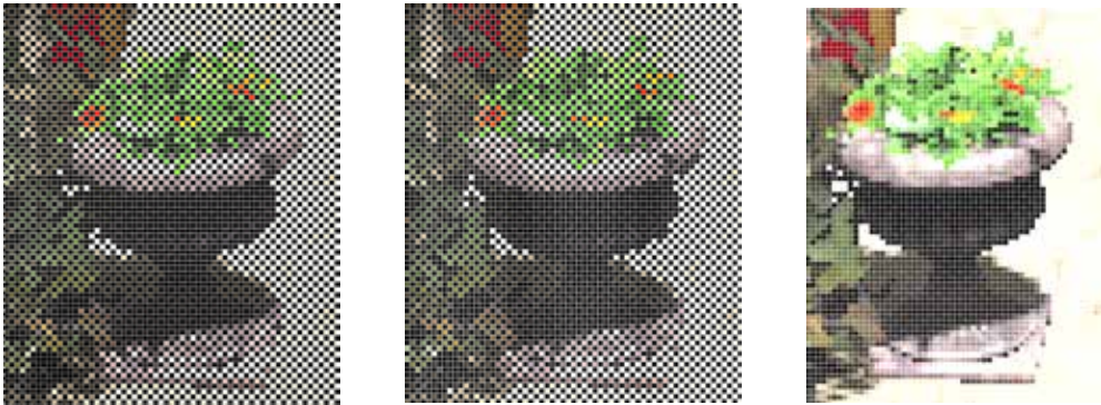
図 8: 2x MSAA バッファのフレーム N-1 とフレーム N。シェーディングがチェッカーボード形式で行われています。左から右へ: フレーム N-1、ビューポートがジッターリングされた フレーム N、再構築されたレンダーターゲット
