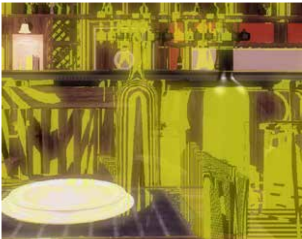
図 19. 左: フレーム N-1 とフレーム N の間にカメラがスクリーン幅の 1/4 を移動しています。黄色でハイライトされた領域は CSO によってシェーディング情報が不足していると判断されたピクセル。 右: 隠されたシェーディング情報は現在のフレームの周辺のピクセルをブレンドして再構築されます。
