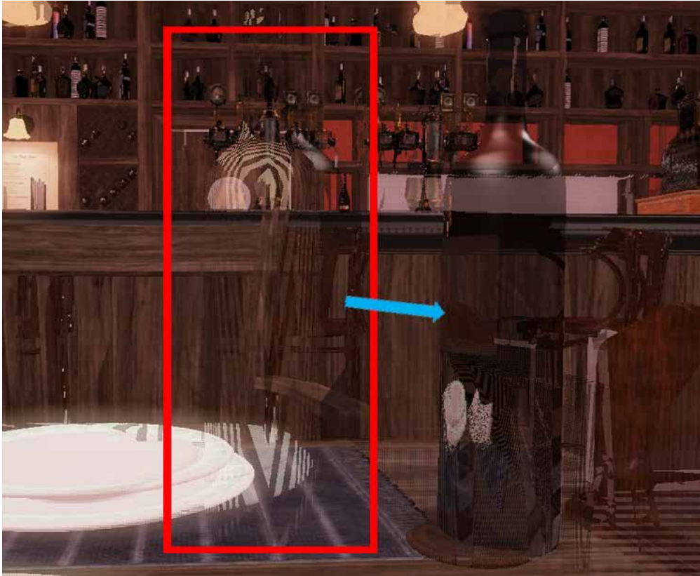
図 18. 赤枠はカウンターの椅子のリゾルブで表示されるアーティファクトをハイライト表示しています。この問題は、フレーム N-1 で必要なシェーディング情報がワインボトルによって隠されているために発生します。
