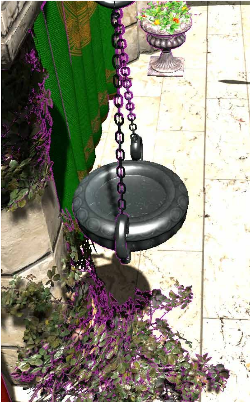
図 22. わずかなカメラの動き。紫色のピクセルは、フレーム N-1 でシェーディング情報が隠されており、推定が必要になります。これにより、追加のエッジロールが発生する可能性があります。
