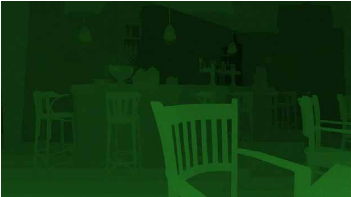
図 16. デプスバッファから取得したピクセルごとのモーションベクトル。カメラは上方向（正の Y）に移動し、ピクセルごとの Y モーションがレンダーターゲットの緑色のチャンネルに反映されます。このシナリオでは、前景オブジェクトのほうがフレーム間のモーションベクトルが大きくなります。
