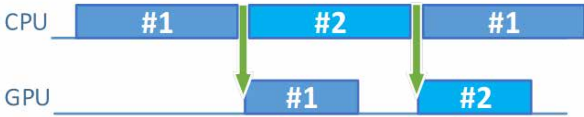
図 8. Pre-submit CPU work time が増えると CPU がボトルネックになる
