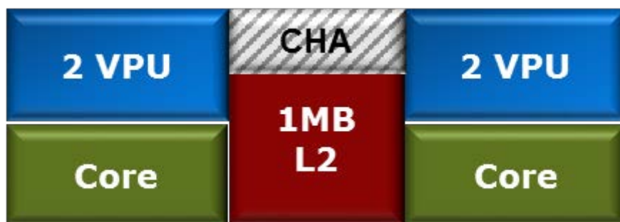
図 1: インテル® Xeon Phi™ プロセッサ x200 製品ファミリーのタイルは、2 つのコア、4 つのベクトル・プロセッシング・ユニット (VPU)、1MB の共有キャッシュ、キャッシュ・ホーム・エージェントで構成される。
