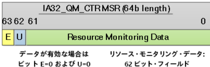
図 6. IA32_QM_CTR MSR は、IA32_QM_EVTSEL MSR で指定された RMID+イベント ID のリソース・モニタリング・データを提供します。E (エラー)/U (利用不可) ビットが設定されていない場合は、データは有効です。
