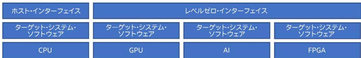
図 1. oneAPI バックエンド・アーキテクチャーのコンテキストのレベルゼロ・インターフェイス
